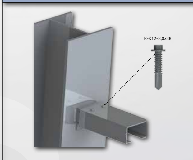
Az acélszerkezet csavarozása
